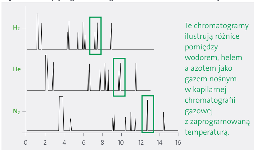
Rysunek 1: Wpływ gazu nośnego na rozdzielczość i czas analizy
